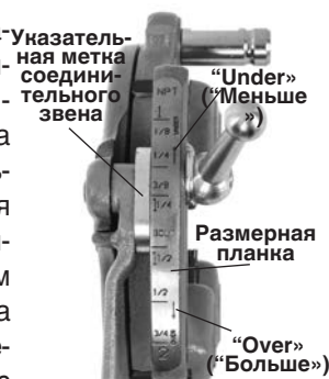
Рис. 9 – Настройка размера резьбы
