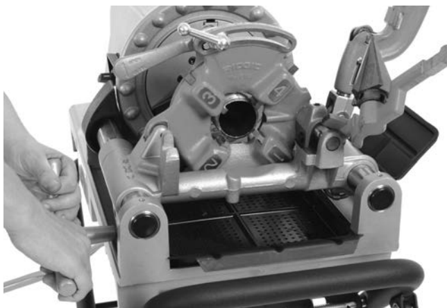
Figure 24 – Filetage des tuyaux (ici, à l'aide d'une tête de filière à ouverture rapide)
